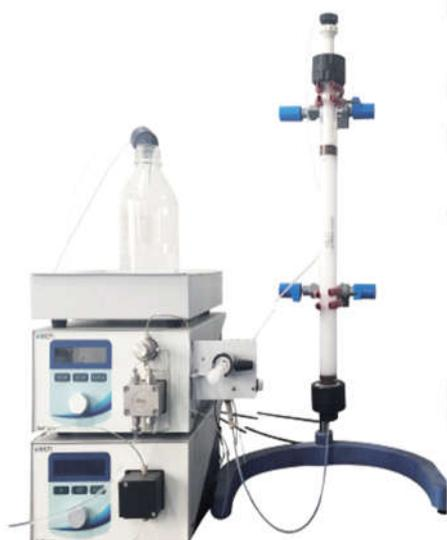
将待净化液经凝胶色谱柱以乙酸乙酯-环己烷（1:1）洗脱，流速 5mL/min，收集 17-31min 馏分，将馏分在 40℃下旋蒸至干，用 1mL 丙酮溶解残渣，待检测。
